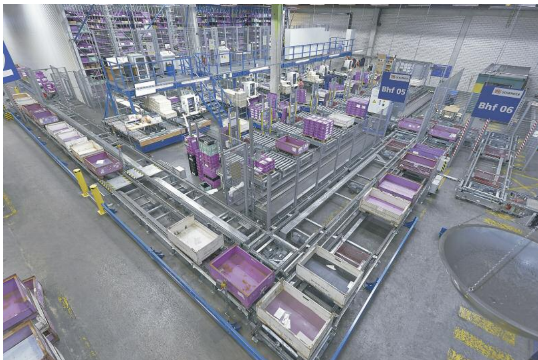
In der Vorzone sind die Arbeitsplätze gut zugänglich angeordnet. Eine 50 m lange Palettenförderstrecke dient als Staustrecke für die Wareneingangs paletten und leeren Transportboxen
